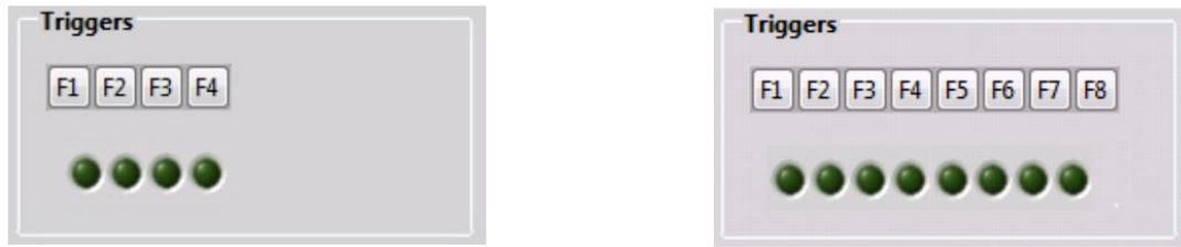
图 11-5 (左) 对于一个 NIRScout 系统, 有四个触发端口和四个手动标记, (右) 对于 NIRScoutX, 有 8 个触发端口和手动标记。
